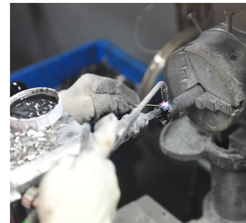
숙련된 기술자가 수동으로 직접 용접해서 팁을 붙이는 모습.
